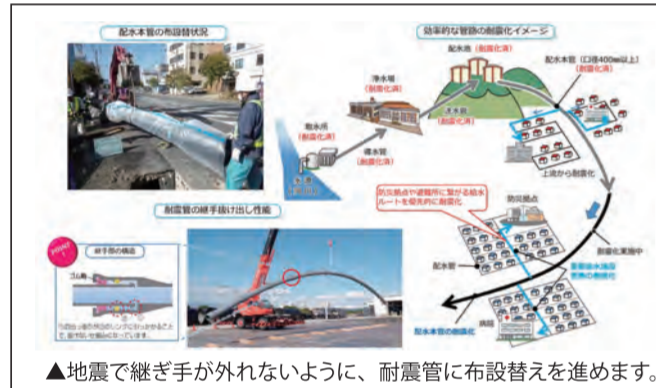
▲地震で継ぎ手が外れないように、耐震管に布設替えを進めます。
